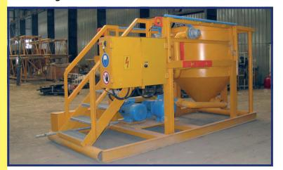
Anlage zum Mischen von flüssigen und pulverförmigen Bestandteilen in Chargen. Die Anlage besteht aus dem Mischbehälter mit Mischverhältnisskala, einer elektrisch angetriebenen Mischpumpe, diversen Steuerklappen und dem Rohrleitungssystem. Frischwasser-Zulauf und Suspensions-Ablauf sind gekennzeichnete 4"-SK-VT-Anschlüsse, wahlweise auch "Storz". Die Zufuhr des Feststoffes in den Mischbehälter erfolgt als Sackware oder über eine Waage mit Förder- und Dosierschnecke.
